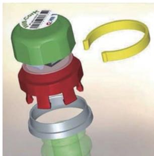
Wifi Cork es un sistema de medición y control no invasivo de la presión y de la temperatura durante la **refermentación en botella**. Permite el almacenamiento de datos en el PC mediante el acceso wi-fi y está compuesto por una serie de dispositivos instalados en un tapón especialmente diseñado, que se acopla en cada una de las botellas y envía una señal a un módulo SB-Reader que recoge los datos y los envía a un PC. Se puede controlar un número elevado de botellas, incluso de diferentes lotes.
